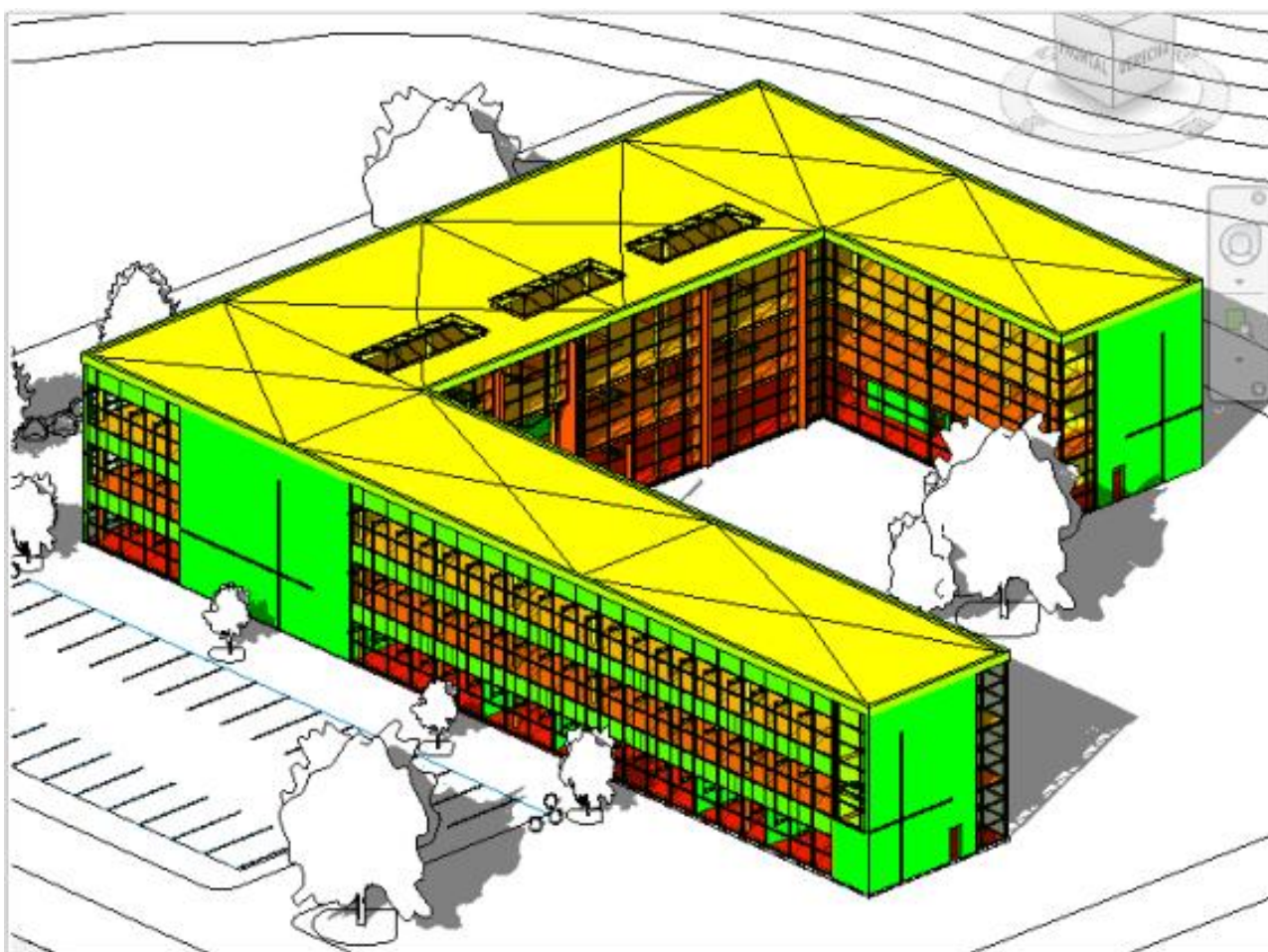
Modelo coloreado con el impacto del indicador GWP-total_A1-A3
